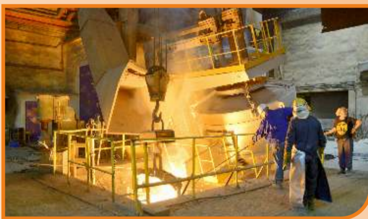
Piec podczas pracy - spustu staliwa 200-400W do kadzi odlewniczej.
