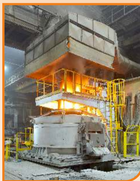
Spółka stawia na ekologię czego przykładem jest nowoczesny system odpylania zainstalowany nad piecem.
