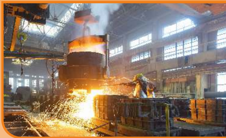
Proces odlewania do form staliwa wytopionego w zmodernizowanym piecu lukowym
