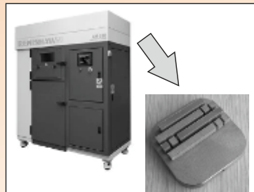
Próbki wykonane techniką SLM (wydruk 3D) z proszku stopu Ti6Al4V pochodzącego z wiórn.
