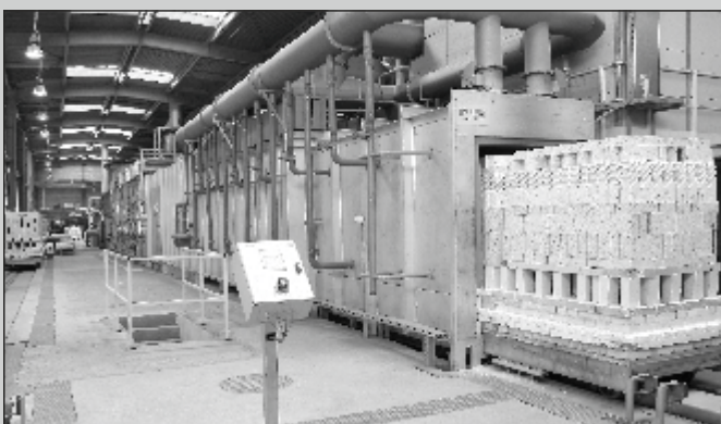
Nowoczesny piec tunelowy z możliwością wypalania materiałów w temperaturze do 1700 st. Celsjusza.
