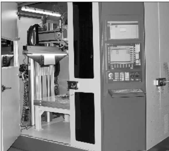
Drukarka 3D do wytwarzania trójwymiarowych obiektów w technologii WAAM, firmy GEFERTEC.
